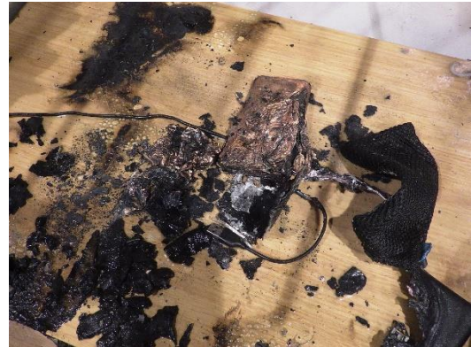
写真10 モバイルバッテリーの焼損状況
