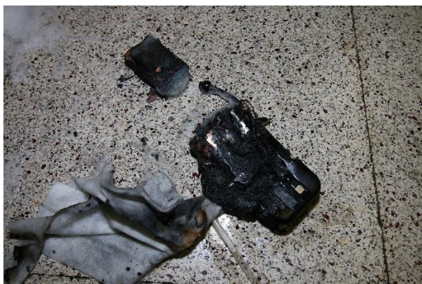
駅ホームで鞆の中のモバイルバッテリーが焼損した状況
