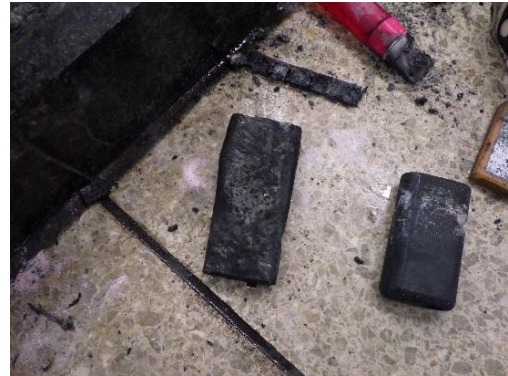
写真2 モバイルバッテリーの焼損状況
